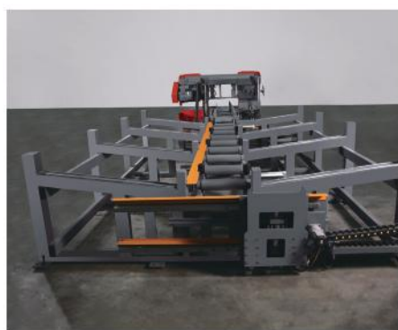
流水线通用自动送料架 左右同时堆放自动翻料
