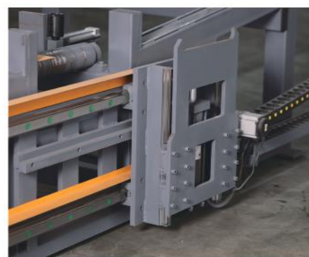
前后双翻料液压机构 直线导轨辅助定位
