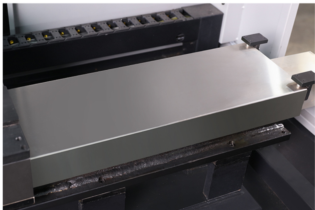
不锈钢防屑护罩 防止运动部件受损
