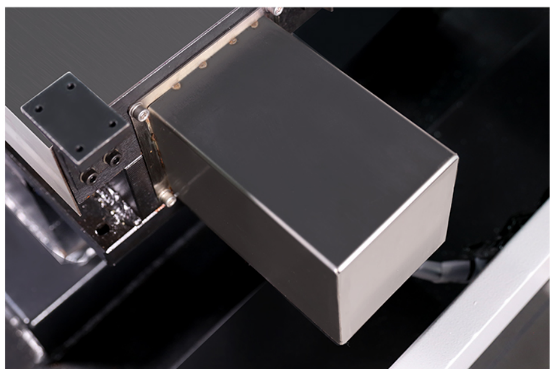
各轴采用绝对值伺服电机 响应更快，更稳
