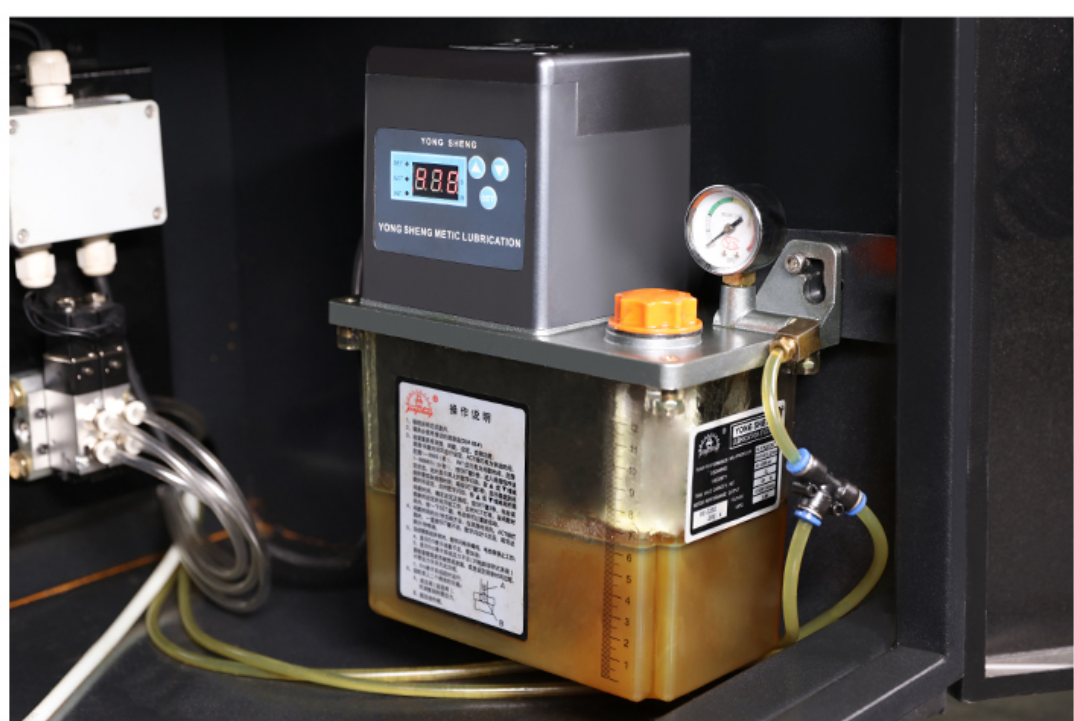
搭载润滑保养油箱 定时定量自动喷油
