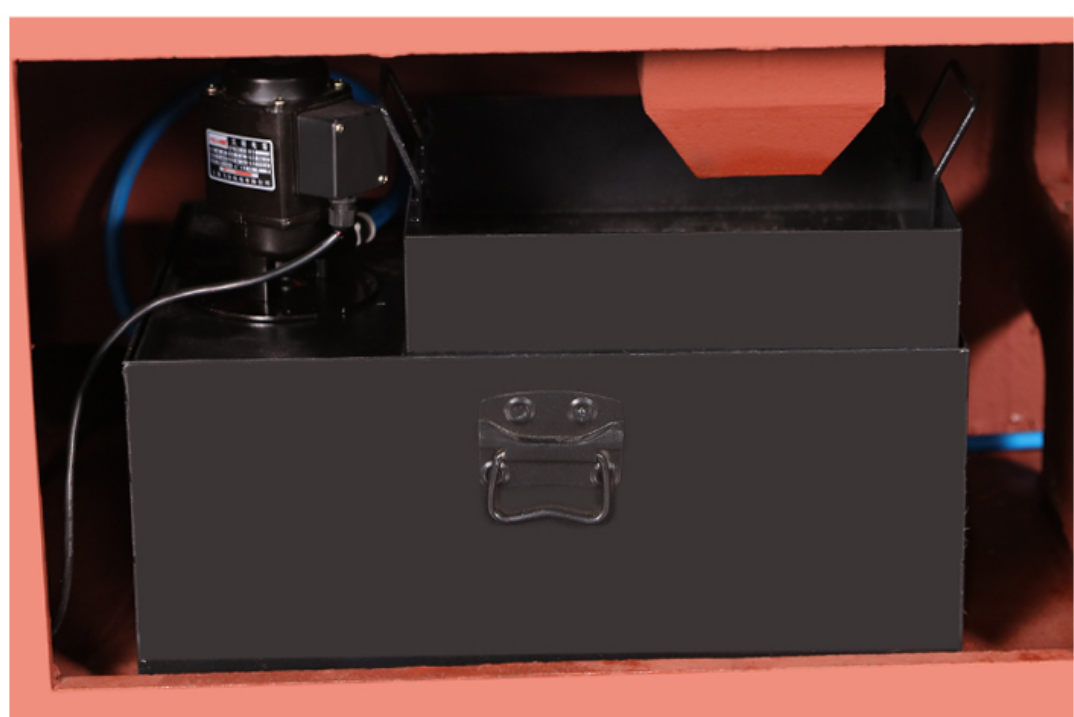
冷却箱配备多层过滤设计 防止铁销回流造成堵塞
